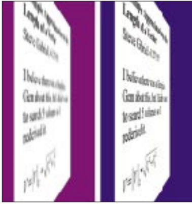
Bild 12: Trilineares Texturemapping (links) und anisotropisches Texturemapping (rechts)
